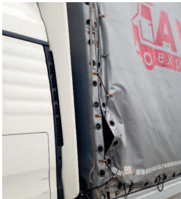
Čiastočne uvoľnená plachta na strane nadstavby automobilu.
