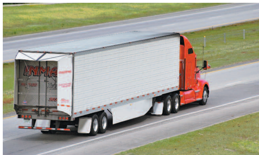
Výrobok ATDynamics. Dobre je viditeľná jednoduchšia konštrukcia bočných platin
